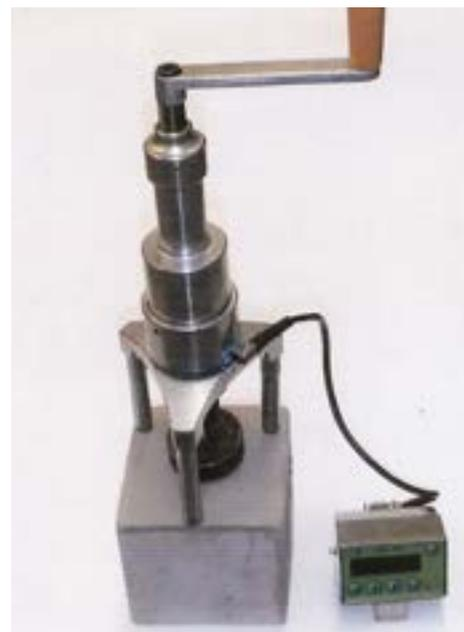
Фото 7. Измеритель прочности сцепления (адгезии) ПСО-10МГ4.
