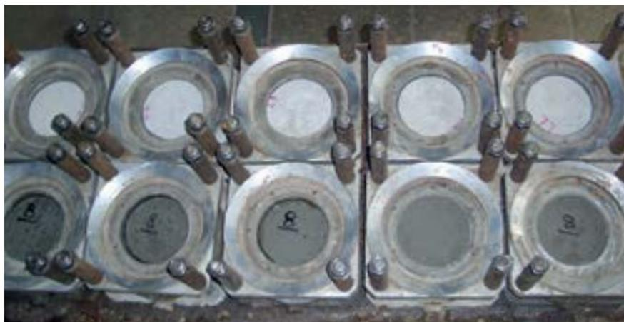
Фото 1. Установка для испытаний образцов на водонепроницаемость.
