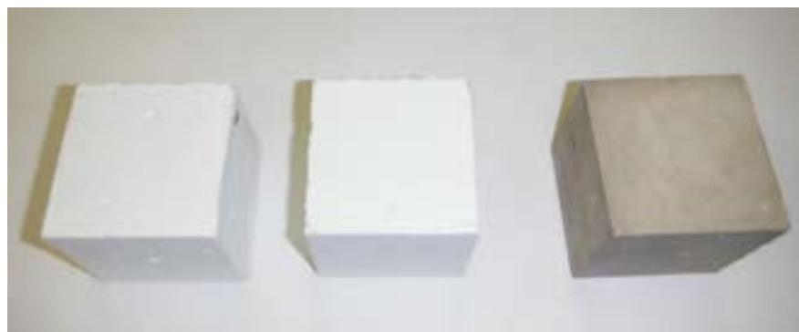
**Фото 4.** Внешний вид образцов перед испытаниями на морозостойкость.
