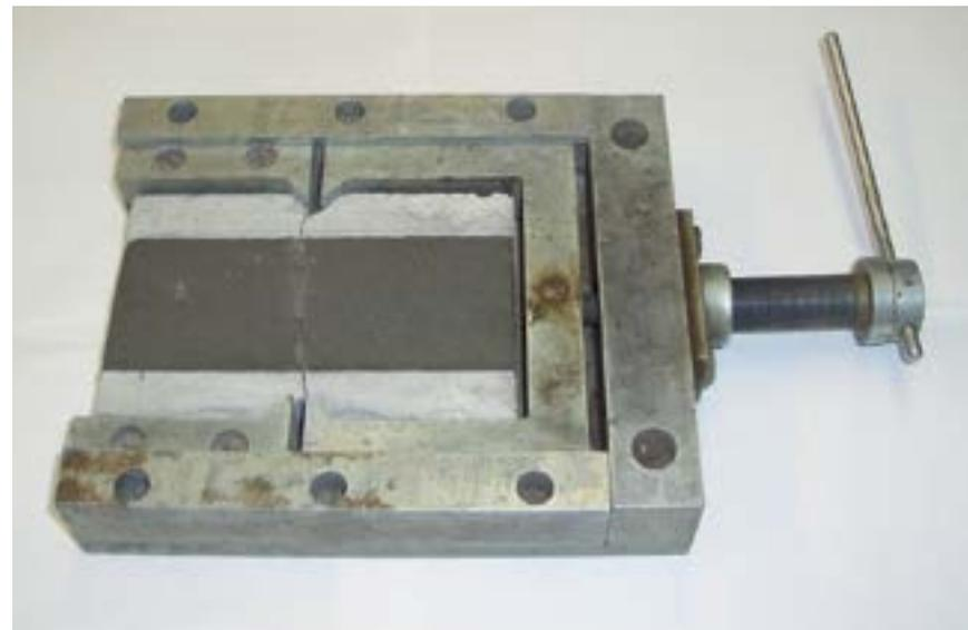
**Фото 6.** Общий вид прибора для определения трещиностойкости покрытия.
