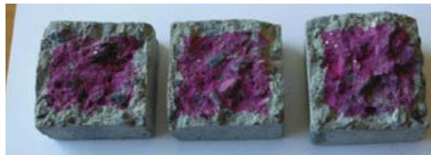
**Фото 14.** Внешний вид контрольных бетонных образцов (без покрытия) после 14 суток испытаний
