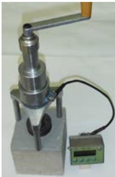
**Фото 9.** Измеритель прочности сцепления (адгезии) ПСО-10МГ4.
