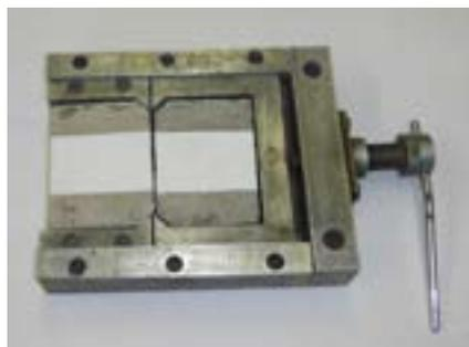
**Фото 8.** Прибор для испытаний на трещиностойкость образцов бетона с покрытием.
