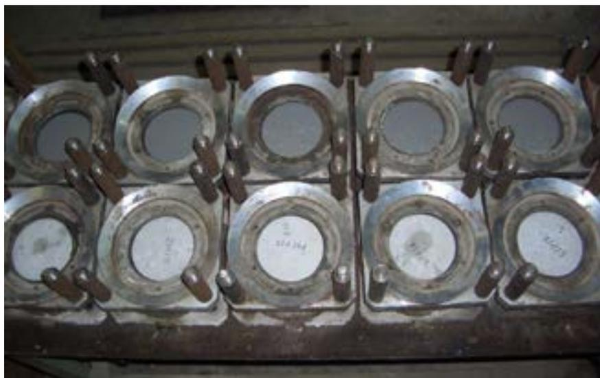
**Фото 1.** Установка для испытаний образцов на водонепроницаемость.
