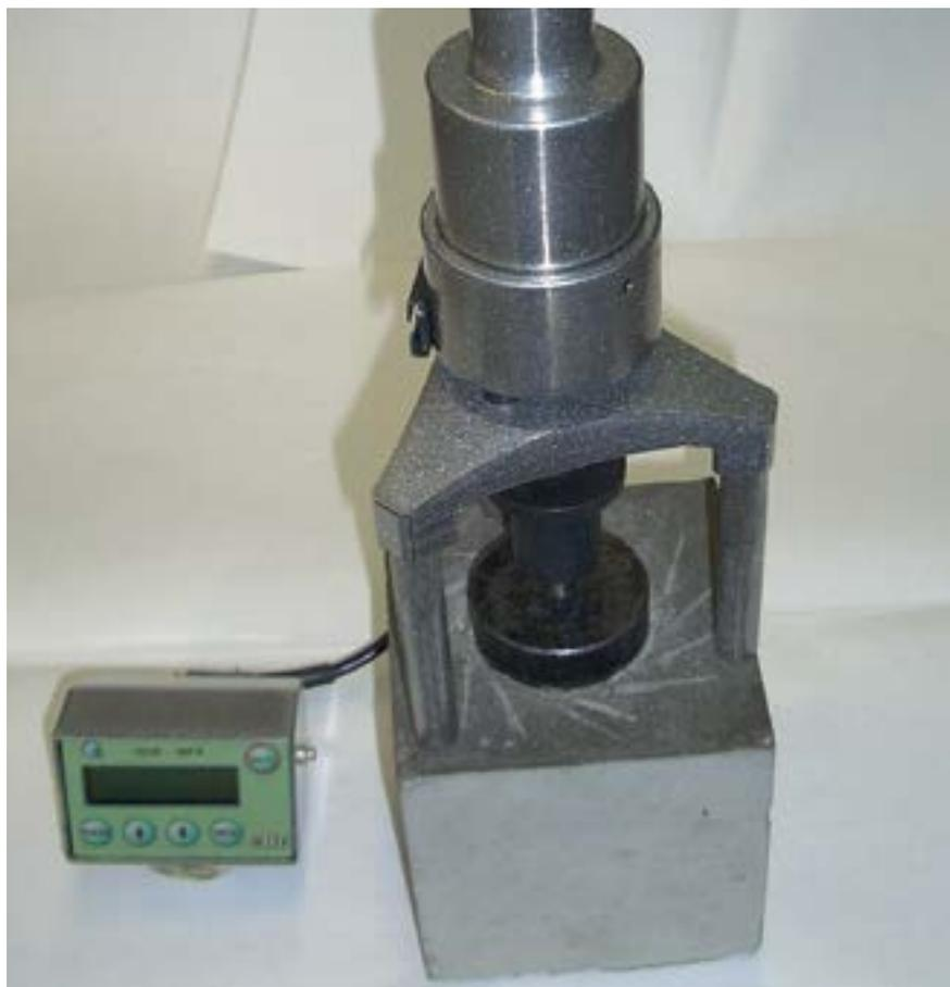
Фото 3. Измеритель прочности сцепления (адгезии) PCO-10MG4.
