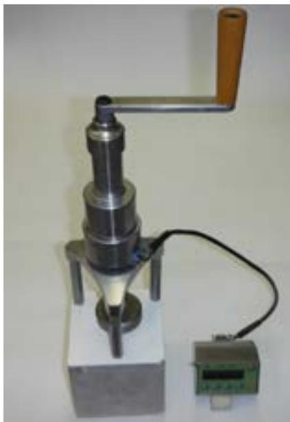
**Фото 9.** Измеритель прочности сцепления (адгезии) PCSO-10MG4.
