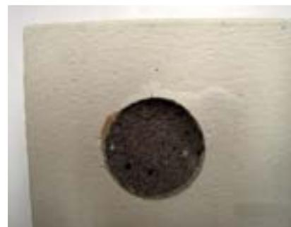
**Фото 5.** Характер разрушения при испытаниях на адгезию образца после 135 циклов ускоренных климатических испытаний (покрытие Elastocolor Paint). Отрыв по телу бетонного основания; прочность сцепления покрытия с основанием больше полученного значения.
