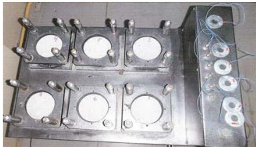
**Фото 3.** Установка УВФ-6/09 для испытаний образцов на водонепроницаемость.
