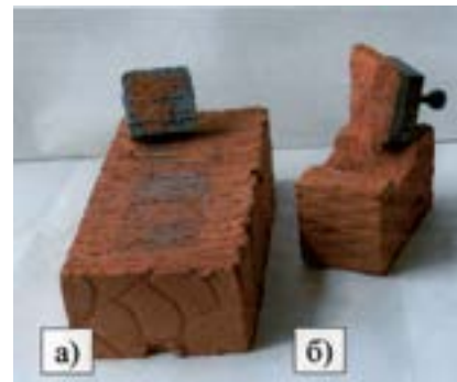
Рис. 3. Характер разрушения при испытании на адгезионную прочность
