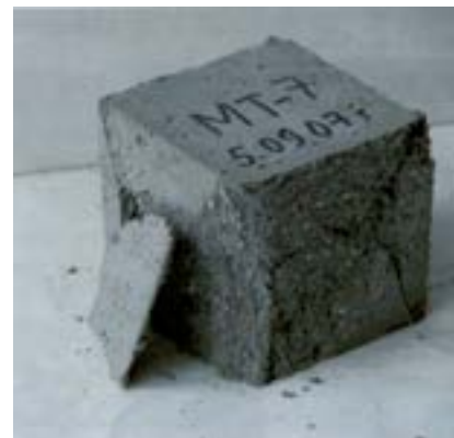
Рис. 1. Характер разрушения образцов при испытании на сжатие.
