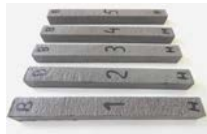
Фото 17. Образцы для испытаний сульфатостойкости по ГОСТ Р 56687-2015 после 5 месяцев испытаний в агрессивной среде
