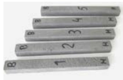
Фото 21. Образцы для испытаний сульфатостойкости по ГОСТ Р 56687-2015 после 6 месяцев испытаний в агрессивной среде
