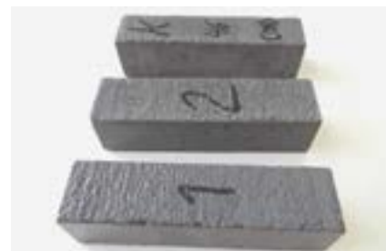
Фото 19. Контрольные образцы для испытаний сульфатостойкости по ГОСТ 27677-88 после 5 месяцев испытаний в агрессивной среде
