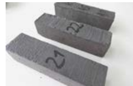
Фото 8. Контрольные образцы для испытаний сульфатостойкости по ГОСТ 27677-88 после 2 месяцев испытаний в питьевой воде
