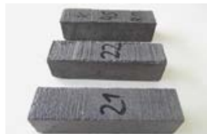
Фото 20. Контрольные образцы для испытаний сульфатостойкости по ГОСТ 27677-88 после 5 месяцев испытаний в питьевой воде
