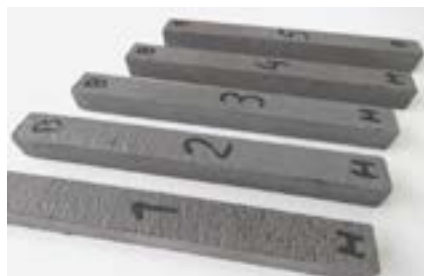
Фото 13. Образцы для испытаний сульфатостойкости по ГОСТ Р 56687-2015 после 4 месяцев испытаний в агрессивной среде
