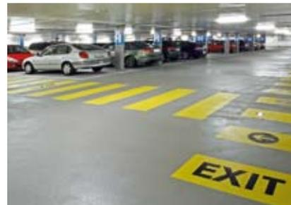
В зонах с высокой механической нагрузкой напольные покрытия парковок должны удовлетворять и более высоким требованиям по стойкости к абразивному износу и уровню гидроизоляции, выдерживать механическую нагрузку от движения транспорта и защищать от проникновения влаги и агрессивных химических сред.
