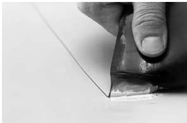
Неразрушающий тест: тест на отдираание вдоль шва (после ручной и автоматической сварки)
