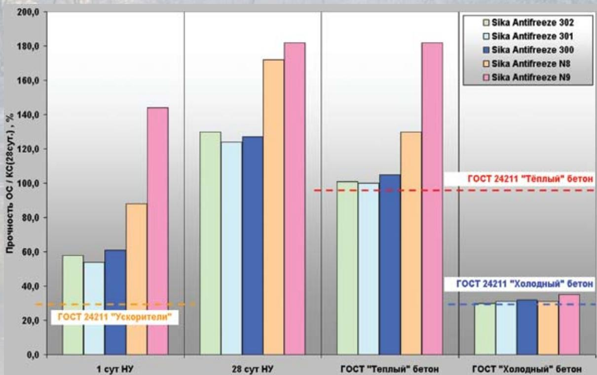
Условные обозначения: ОС – основной состав с добавкой, КС – контрольный состав без добавки, пунктирные линии обозначают минимальные требования ГОСТ 24211-2008.
