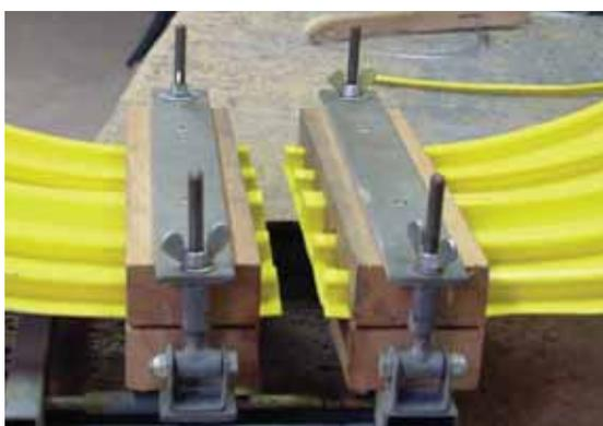
3. Зажать концы свариваемых гидрошпонок в шаблонах кондуктора параллельно друг другу таким образом, чтобы при смыкании между концами гидрошпонок не было зазоров.
