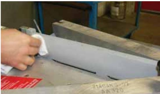
6. Очистка нагревательного элемента проводится после каждой сварки и только с помощью ветоши. Не допускаются повреждения поверхности нагревательного элемента.
