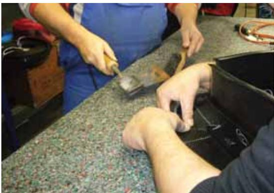
7. В процессе работ нагревательную часть электрического топора необходимо очищать металлической щеткой. Такая очистка проводится после сварки каждого участка, примерно через каждые 2–3 см.
