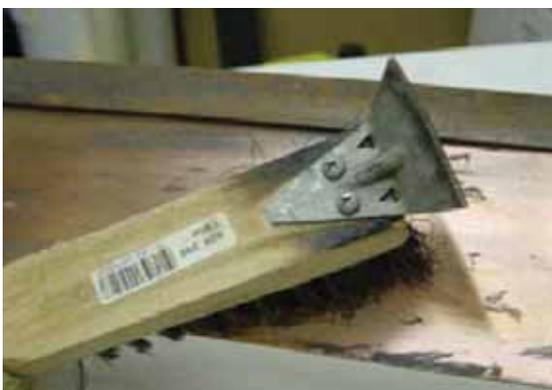
8. В конце работ медная нагревательная пластина очищается металлической щеткой. Сварной шов после остывания проверяется на герметичность с помощью искрового тестера.
