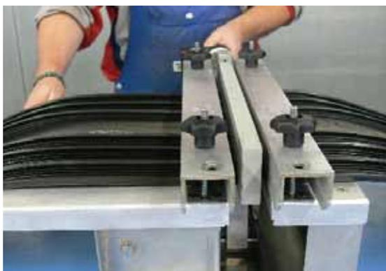
3. Поднять нагревательный элемент в рабочее положение между концами гидрошпонок, зажать кондуктор. Этап прижима:
