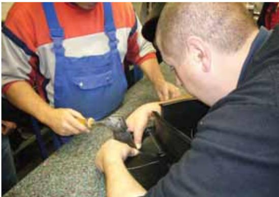
5. Сварка проводится короткими участками по 2–3 см, медленно, чтобы шпонка успела достаточно расплавиться. Сварной шов обязательно должен иметь сварной валик из расплавленного материала. Перед началом сварки каждого последующего участка, шпонку надо немного растянуть в месте последнего сваренного участка, чтобы надорвать места возможного непровара.
