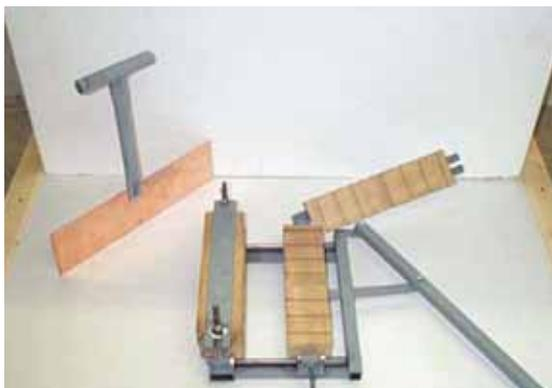
1. Сварка осуществляется с помощью кондуктора, медной нагревательной пластины и деревянных шаблонов под каждый тип шпонки, которые вставляются в кондуктор.
