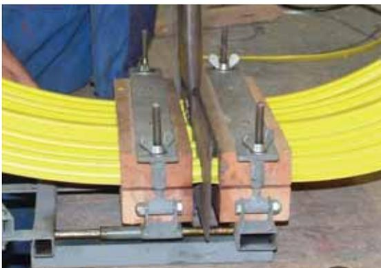
5. Поместить нагретую медную пластину между концами гидрошпонки и прижать торцы к пластине на 10–15 сек.
