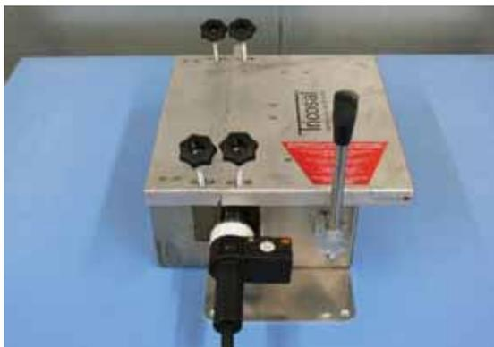
1. Перед началом работ нагревательный элемент сварочного аппарата подключается в сеть и нагревается до заданной температуры 220 °С.
