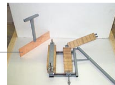
■ кондуктор для сварки гидрошпонок
