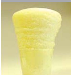
Свободное расширение Sika® Injection-101 до 40 раз.
