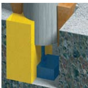
Установка готовых ,сборных конструкций в фундамент
