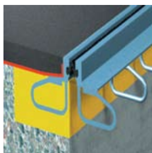
Подливка при устройстве швов
