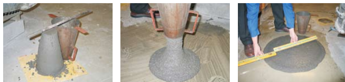
до и после добавления 1% Viscocrete 5-600
