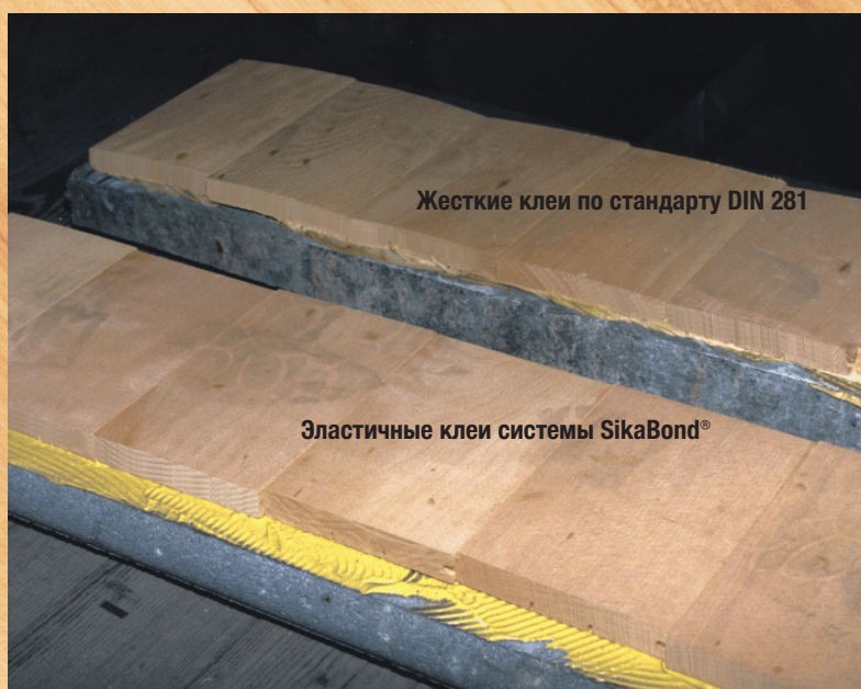
Рис.5: Испытания при воздействии экстремальных нагрузок: массивная доска из бука толщиной 21 мм, влажность древесины 22%
