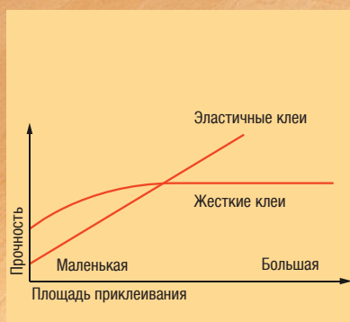
Рис.3: Зависимость прочности клеевого шва от площади приклеивания.
