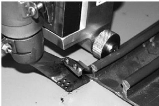
Сварные швы гидрошпонки должны быть сошлифованы или срезаны заподлицо с поверхностью самой гидрошпонки.
