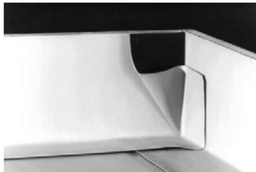
Отрежьте и уложите вторую полосу с заходом на вертикальную поверхность, таким образом, чтобы величина нахлеста на горизонтальной и вертикальной поверхностях была одинаковой. Таким образом сформируется складка.
