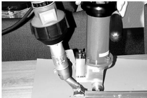
**Приварка горячим воздухом гидрошпонки на уложенную гидроизоляционную мембрану с использованием полуавтоматического сварочного аппарата Leister Triac Drive:**
