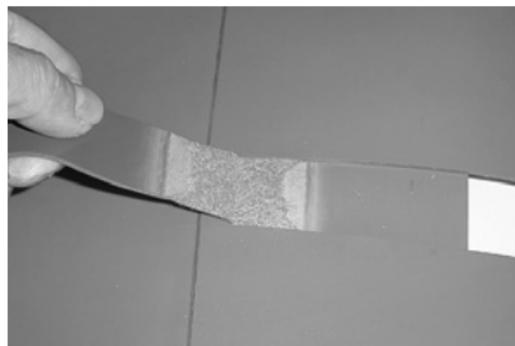
**Разрушающий тест: тест на сдираание поперек сварного шва (при автоматической или ручной сварке)**
