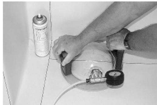
В случае длинных швов продвигайте колпак вдоль шва. При движении вдоль шва необходимо, чтобы сварной шов был проверен полностью, без пропусков.
