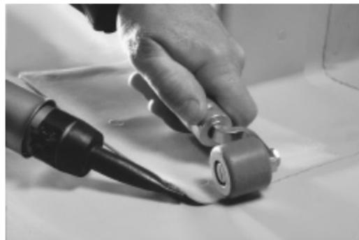
Для получения оптимального качества сварного шва необходимо, чтобы сопло - насадка для сварки была непосредственно в зоне сварки.
