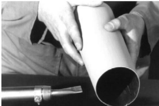
Равномерно прогрейте не заваренный конец заготовки...
