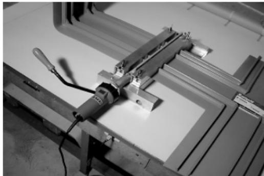
Доведите температуру нагревательного ножа до 420 °С и расположите его между двумя отрезками гидрошпонок. Поворотом рычага прижмите отрезки шпонок **Sika® Waterbar** друг к другу с небольшим усилием, пока по всему периметру шпонок не появится расплавленный участок шириной примерно 1 мм.
