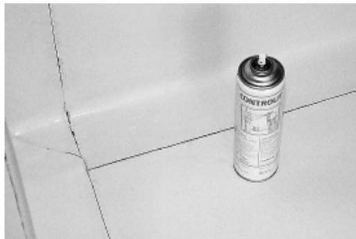
Распылите на поверхность, которую собираетесь проверять жидкость образующую пузырьки, например мыльную воду или специальный спрей для обнаружения протечек.
