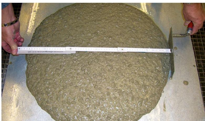
Проверка качества набрызг-бетона
