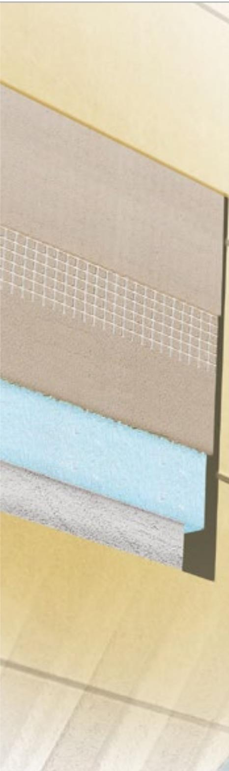
При использовании цветного грунта, особенно ярких цветов, отделка будет более ровной, а кроющая способность увеличится. Нельзя использовать грунт на основе растворителя, он может вступить в реакцию с изоляционной панелью, изменить ее характеристики и привести к отслаиванию от выравнивающего слоя.
