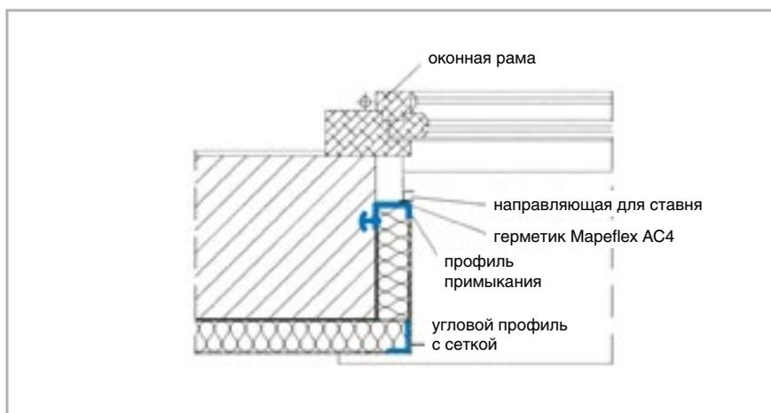
П. 17 – Вертикальный разрез конструкции типа наружной колонны
