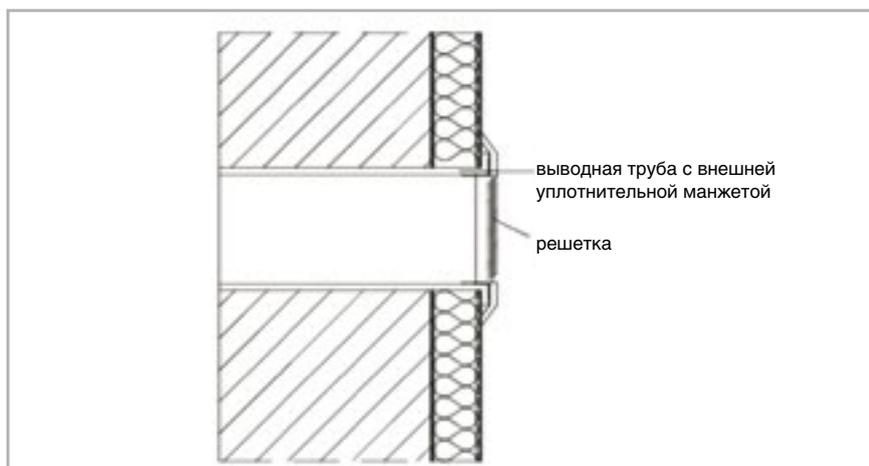
П. 6 – Вертикальный разрез трубы
