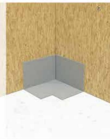
**3** В случае гидроизоляции стены с односторонней опалубкой верхний край мембраны должен находиться на расстоянии не менее 200 мм от фундаментной плиты и быть закреплен без каких-либо повреждений. Мембрана MasterSeal 754 должна быть установлена и закреплена на высоте не менее 200 мм над верхней частью любой опалубки. В торце мембрана фиксируется на вертикально закрепленную ленту MasterSeal 934, продольно мембраны соединяются посредством самоклеящихся частей.
