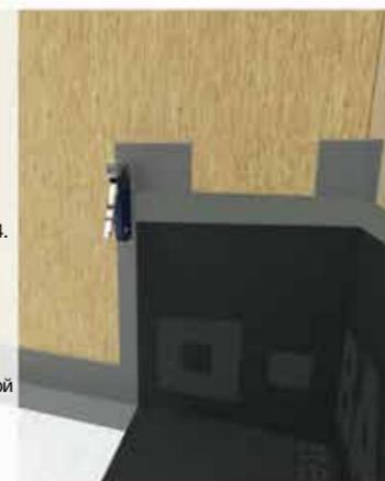
**6** Все торцевые соединения следует выполнять с помощью ленты MasterSeal 934 200 мм, при укладке мембран в середине ленты должен образоваться ровный шов не более 5 мм для обеспечения полной герметичности.
