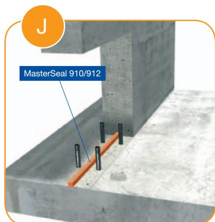
**Прокладка саморасширяющегося шнура** в рабочий шов на стадии бетонирования для предотвращения проникновения грунтовой воды
