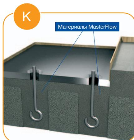
**Одновременное заполнение шанцевых колодцев и зазора между опорной плитой и фундаментом** с применением быстротвердеющих безусадочных смесей серии MasterFlow
