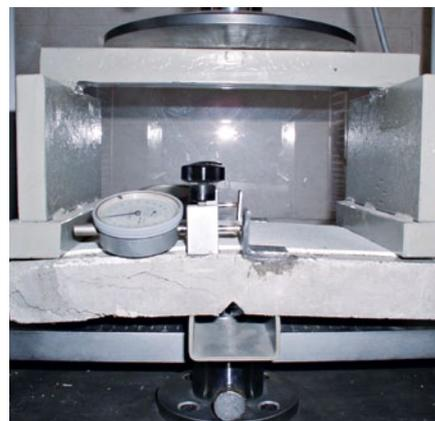
**Статическое испытание перекрытия трещин согласно стандарту EN 1062-7 (метод А)**
