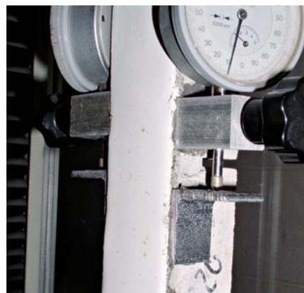
**Динамическое испытание перекрытия трещин согласно стандарту EN 1062-7 (метод В)**
