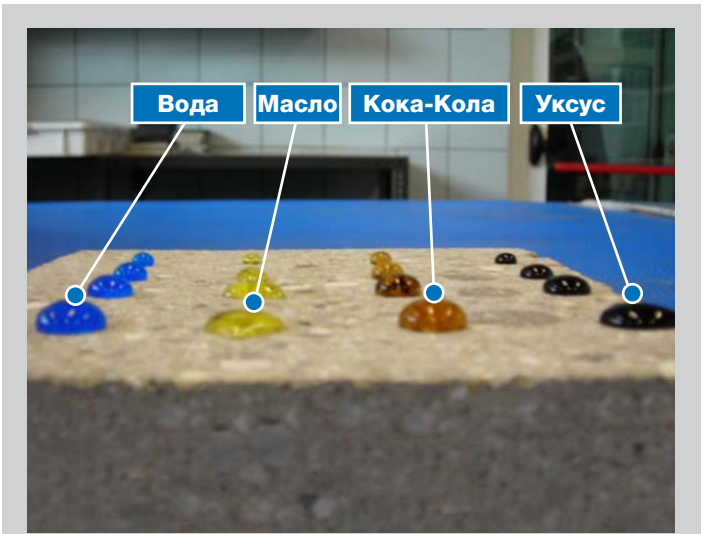
Воздействие на поверхность после нанесения Mapecrete Stain Protection
