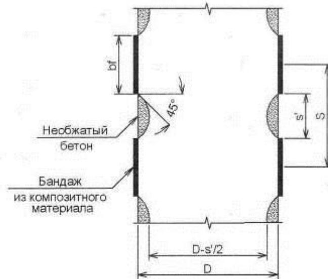
Рис. 6.2.4. Усиление колонны отдельными бандажами по высоте.
