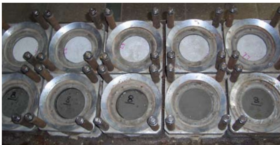
Рис. 1.1. Установка для испытаний образцов на водонепроницаемость.
