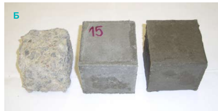
Рис. 1.2. Внешний вид образцов после испытаний на морозостойкость.
