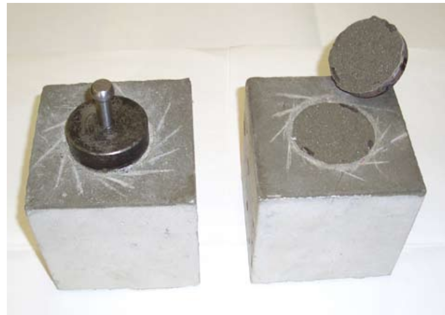
Рис. 1.5. Внешний вид образцов бетона с покрытием Mapelastic до и после испытаний на адгезию.
