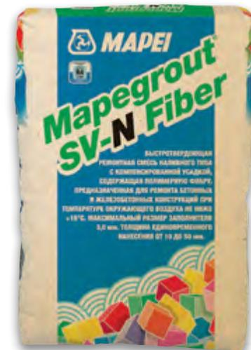
Сверхбыстротвердеющая растворная смесь наливного типа, содержащая полимерную фибру. Благодаря быстрым срокам схватывания (до 30 мин.) и часовому набору прочности (30 МПа через 2 часа) позволяет провести максимально быстрый ремонт на оживленных участках дорог с интенсивным движением. Максимальный размер заполнителя 3,0 мм.
