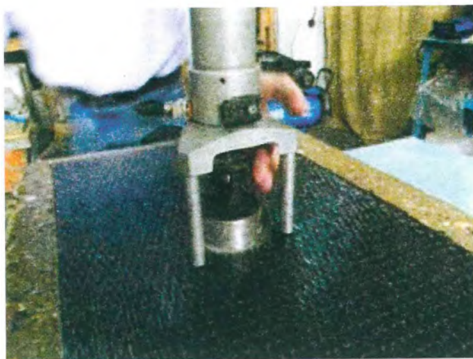
Рисунок Д.8 – Подсоединение адгезиметра к анкеру
