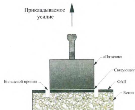
Рисунок Д.1 – Схема приложения отрывающего усилия к пластине («пятачку»)
