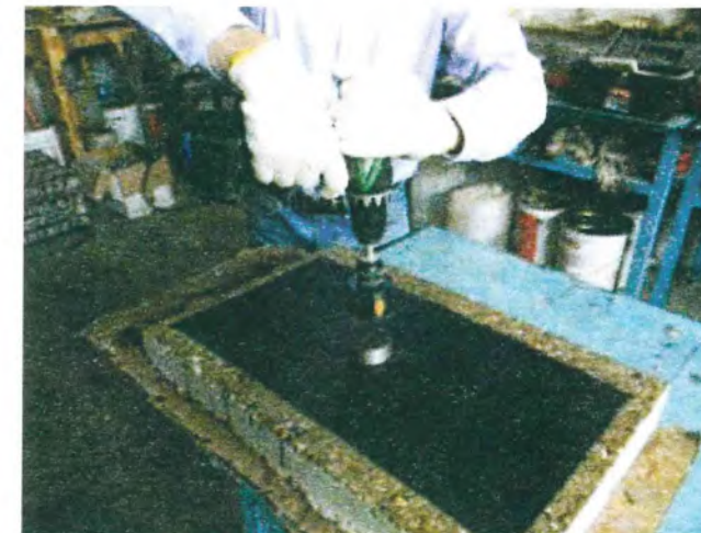
Рисунок Д.7 – «Пятачок» с ввинченным в него анкером-«грибком»
