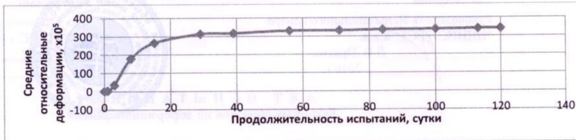
Рисунок 1. Изменение величины относительной деформации усадки затвердевшего раствора во времени
