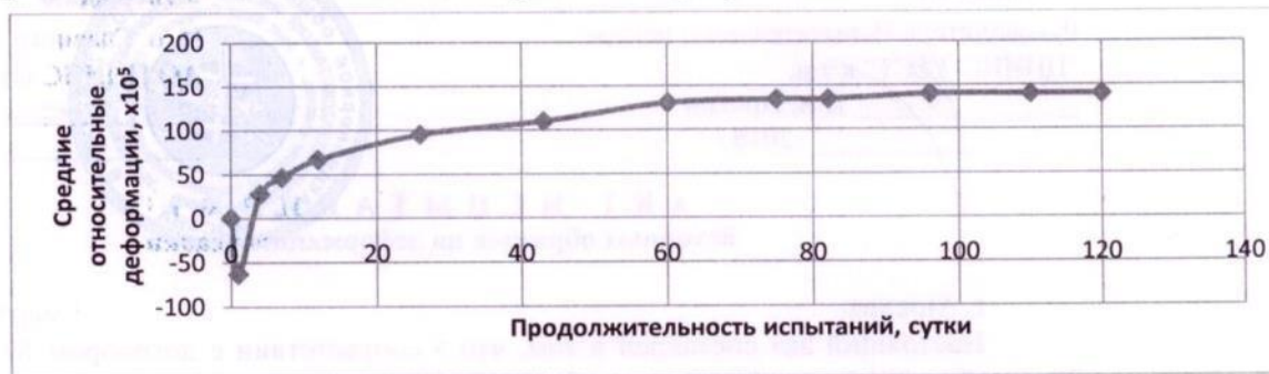
Рисунок 1. Изменение величины относительной деформации усадки затвердевшего раствора во времени
