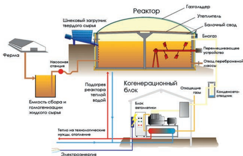
Рисунок 4.5.3 – Принципиальная схема работы биогазовой установки
