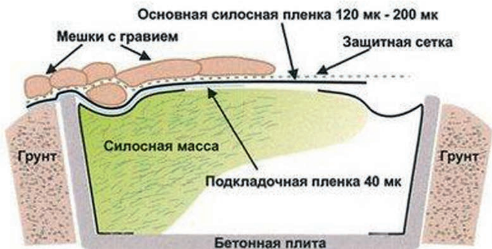
Рисунок 4.2.6 – Схема силосной ямы
