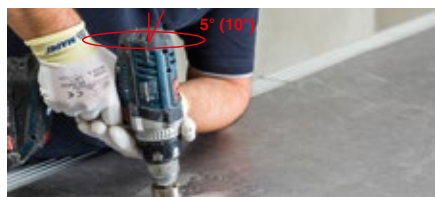
Порядок действий по созданию круглого отверстия
