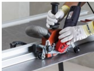
Прямолинейная резка с помощью УШМ
