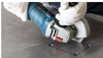
Порядок действий по созданию прямоугольного отверстия
