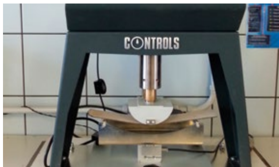
Измерение деформируемости цементных клеев
