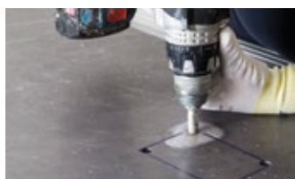
Порядок действий по созданию прямоугольного отверстия
