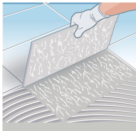
Отличное смачивание обратной стороны плитки
