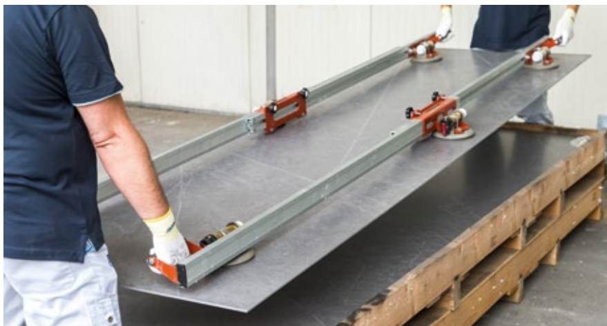
Правильное перемещение плитки
