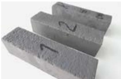
**Фото 11.** Контрольные образцы для испытаний сульфатостойкости по ГОСТ 27677-88 после 3 месяцев испытаний в агрессивной среде
