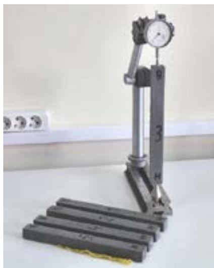
**Фото 4.** Испытание образцов по ГОСТ Р 56687-2015
