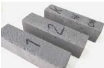
**Фото 15.** Контрольные образцы для испытаний сульфатостойкости по ГОСТ 27677-88 после 4 месяцев испытаний в агрессивной среде
