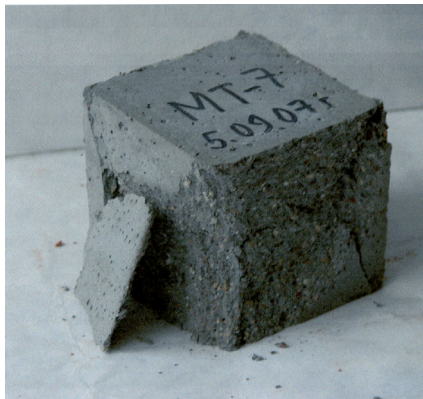
Рис. 1. Характер разрушения образцов при испытании на сжатие.
