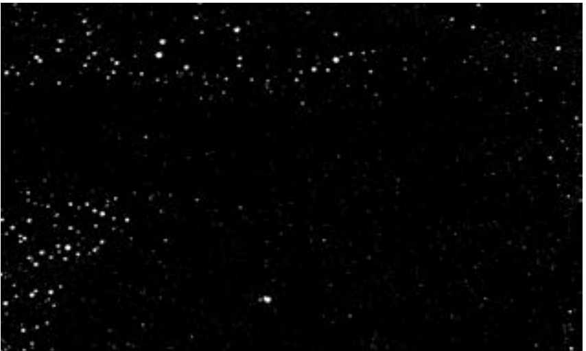
Контрастный анализ, определяющий степень пористости поверхности для определения поверхностной пористости анкерочного раствора. В его ходе поверхность окрашивается, а в полости добавляется заполнитель. Затем избыток заполнителя удаляется, и с помощью программы анализа изображений измеряется отношение пор к общей площади поверхности.
