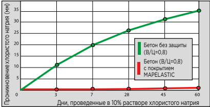
Рисунок 3. Защита пористого бетона с помощью Mapelastich от проникновения хлорида натрия
