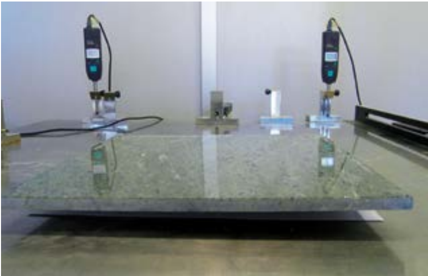
Пример деформации каменной плиты под воздействием влаги
